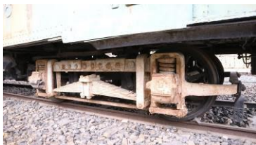
モ 766 の台車 路面電車によくあるタイプ
