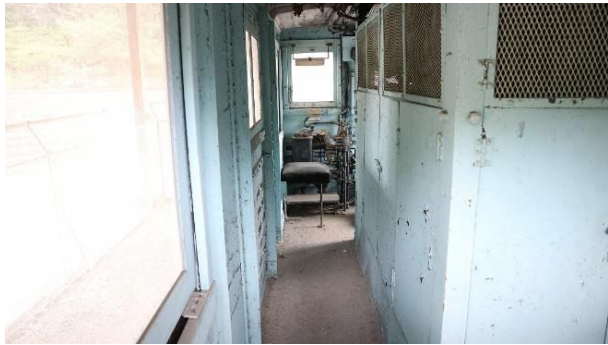
デキ 202 の車内 狭い通路以外は機器室で占められている
