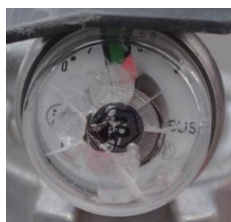
× 指示圧力計の損傷
