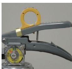
× レバー支えの脱落
