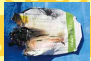
発火したモバイルバッテリー
