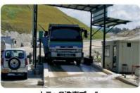
トラック洗車プール 鉱山内にトラックの足場洗浄を設置し、公道 へ出る前にタイヤに付着した砂、泥などを洗い 落とします。
