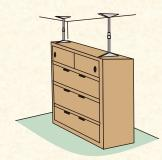
壁面へのネジ留めができないときは、天井と家具の間に突っ張り棒タイプの器具をはさむ固定法が使えます。この場合、天井までの距離が短いほど安定感は増します。家具の両側の側板部の奥側に設置しましょう。
